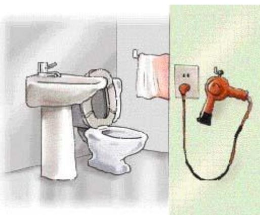
插頭累積塵埃容易結合水分，使原本分開的兩極行成通路，造成積污導電現象而短路，由於大量電流過發熱導致火災。
