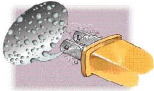
拔下延長線插頭時，應手握插頭取下，不可僅拉電線，而造成電線內部銅線斷裂。
